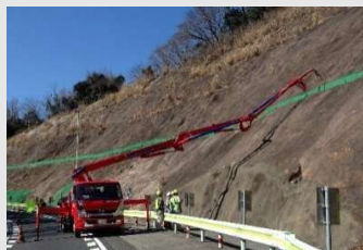
▲写真Ⅱ-2-11 コンクリートポンプ車を活用した点検ロボットによる橋梁・路面点検
