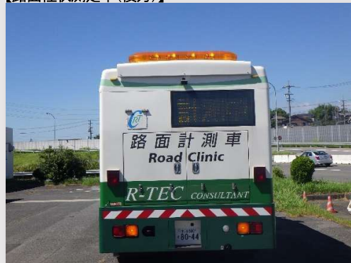
【路面性状測定車(後方)】
