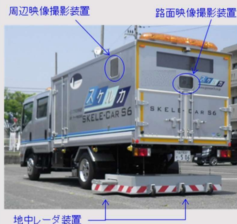
▲写真 3-11 床版現場調査の状況
